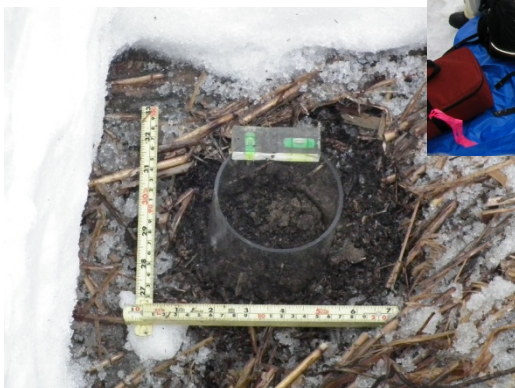
浸透能試験器をセットしたところ
