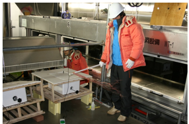
融雪箱に雪を充填しているところ (気温7.0°C、風速10m/sの実験はさすがに寒く、防寒服を着て各種の計測を行いました。)
