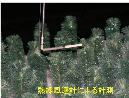
熱線風速計による計測
